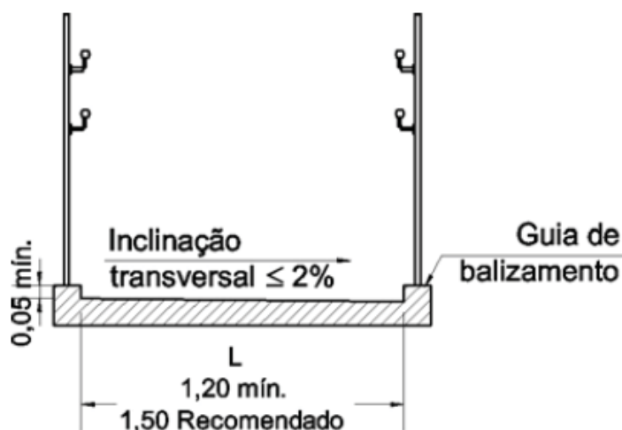
Figura 19 – Inclinação transversal e largura das rampas
