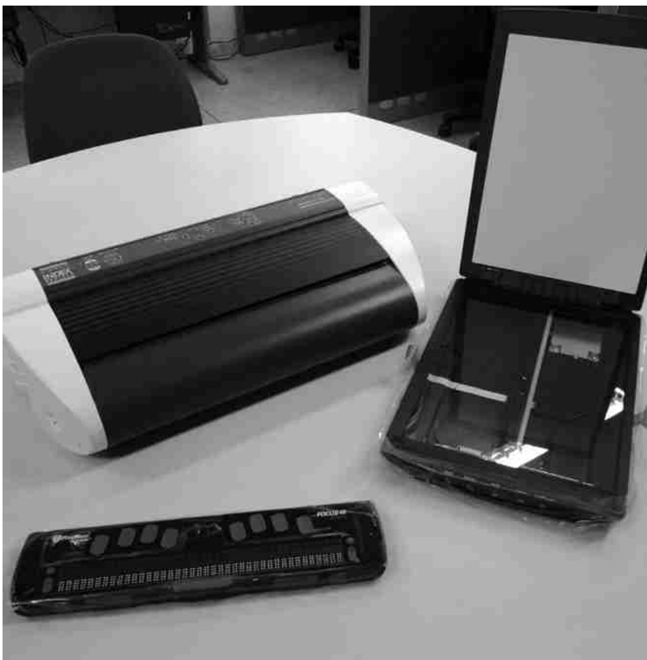
Impressora Braille, Scanner com voz/OCR e Linha Braille (da esquerda para a direita em sentido horário)
